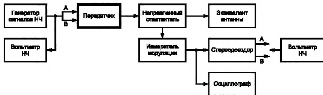
Рисунок 29 — Схема измерения неравномерности АЧХ в режиме СТЕРЕО
