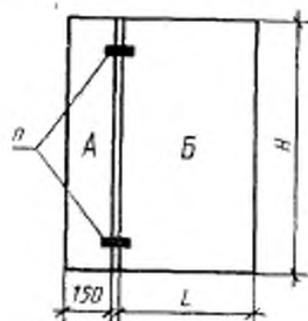
А — часть бокового щита изделия, к которому крепится дверь; Б — дверь; H, L — соответственно высота и ширина двери; 150 — петли, устанавливаемые в соответствии с конструкторской документацией
