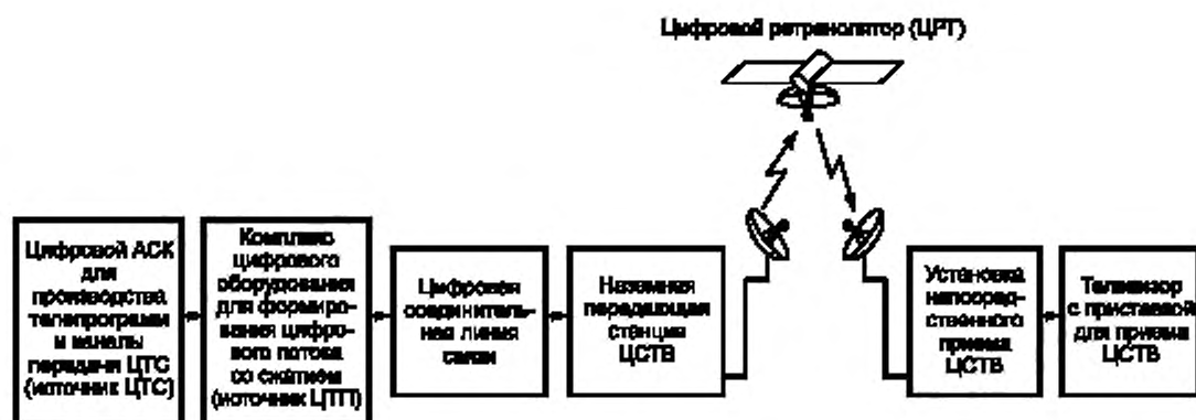
Рисунок Б.2 — Структурная схема типового тракта цифрового спутникового телевидения (ЦСТВ)
