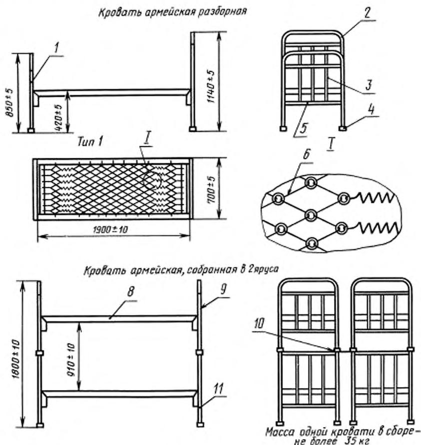
1 — колонка; 2 — дуга; 3 — стойка; 4 — подножник; 5 — поперечина; 6 — ромбическая сетка; 8 — рама; 9 — низкая спинка; 10 — соединительная пластина; 11 — высокая спинка
