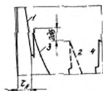
1 — импульс шума; 2 — первоначальное положение контрольного импульса; 3 — положение контрольного импульса в режиме отсчета; 4 — донный эхо-сигнал
