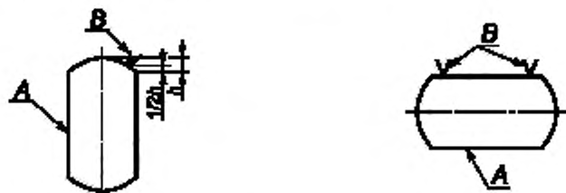
а — Положение термодпар для металлических баков
