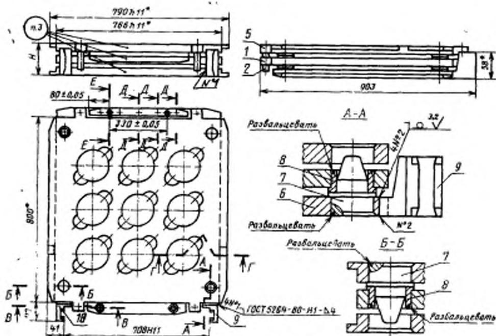
1—средняя кассета по табл. 1; 2—упор 1007-1021/002 (кол. 4); 3—штулка 1007-1021/003 (кол. 2); 4—плавка 1007-1021/004 (кол. 1); 5—верхняя кассета по табл. 1; 6—нижняя кассета по табл. 1; 7—колонка по табл. 2; 8—штулка по табл. 2; 9—захват 1007-1001/003 ГОСТ 26609—85 (кол. 1); 10—захват 1007-001/004 ГОСТ 26609—85 (кол. 1); 11—винт М8×30,88 ГОСТ 11738—72 (кол. 5); 12—шайба 8 65Г00 ГОСТ 6402—70 (кол. 5); 13—шрифц 10тв8×30 ГОСТ 3128—70 (кол. 2)
