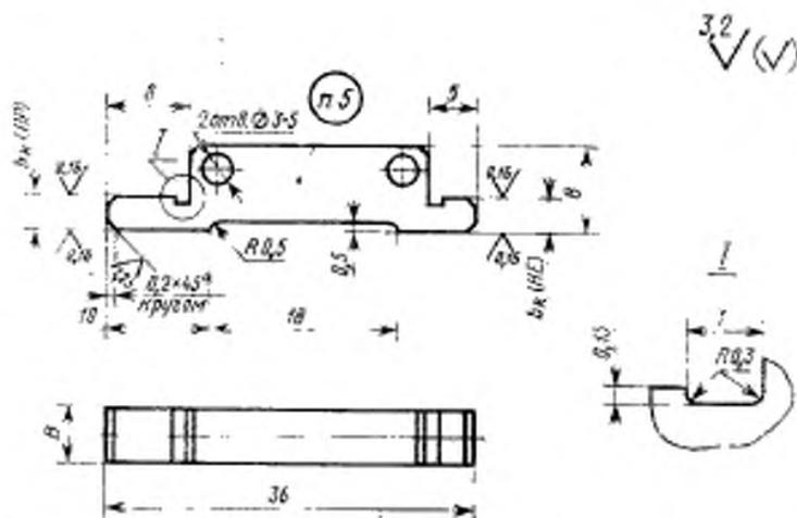
Примечание. Допускается не изготавливать отверстия диаметром 2 мм.
