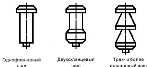
Рисунок 1 — Виды шипов по количеству фланцев
