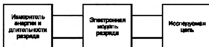
Рисунок А.26 — Блок-схема установки для электроизмерительной оценки параметров разряда
