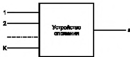
Рисунок В.1 — Общий вид схемы устройства сложения с обозначением входов и выхода
