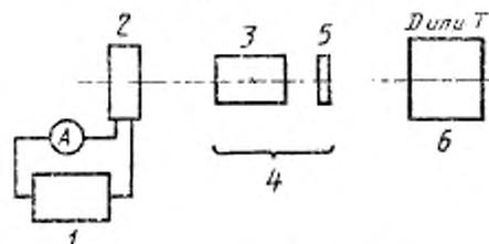
$D$  или  $T$  — измеряемый прибор; 1 — источник питания; 2 — источник света; 3 — монохроматор; 4 — по выбору; 5 — фильтр; 6 — оптическая ось (варианты 1 и 2) или механическая ось (вариант 3).
