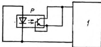
$P$  — измеряемая фотопара;  $I$  — измеритель емкости
