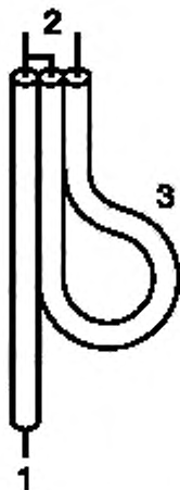
1 — несимметричный вход; 2 — симметричный выход; 3 — полуволновая петля
