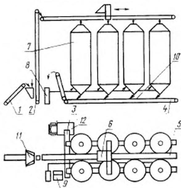
1—5—устройства транспортирования кормов, 6—устройство распределения; 7—бункеры; 8—оборудование создания РГС (РТ); 9—система управления; 10—система развозки РГС (РТ); 11—устройство приемки; 12—автотранспорт
