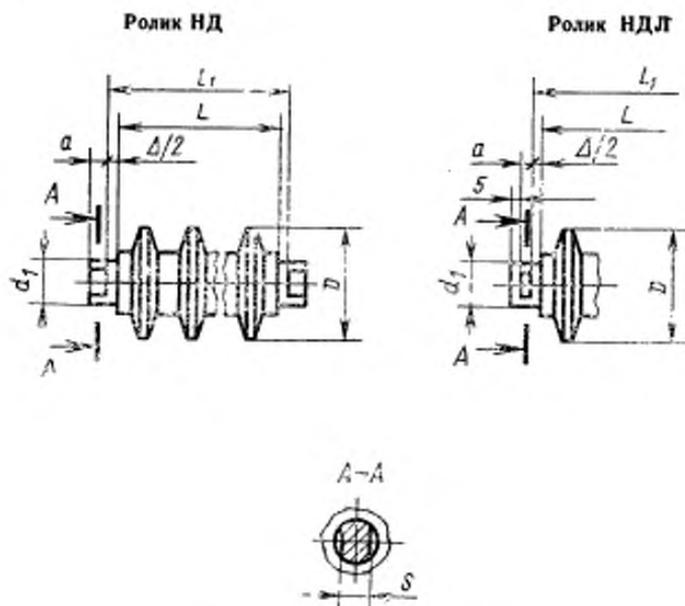
Примечание. Чертеж не устанавливает конструкцию роликов.
