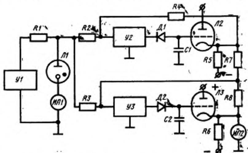
$R_1$ — $R_8$ —резисторы;  $C_1$ ,  $C_2$ —конденсаторы;  $D_1$ ,  $D_2$ —диоды;  $ИП1$ —измеритель тока;  $ИП2$ —измеритель напряжения;  $L_1$ —испытываемый стабилизатор;  $L_2$ ,  $L_3$ —триоды;  $U_1$ —регулируемый источник постоянного напряжения;  $U_2$ ,  $U_3$ —усилители постоянного тока.
