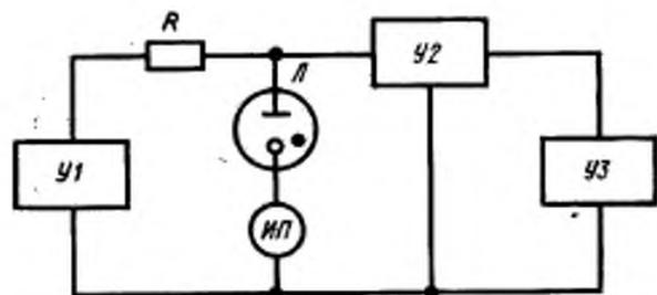
$R$ —резистор;  $ИП$ —измеритель тока;  $I$ —испытываемый стабилитрон;  $U1$ —регулируемый источник постоянного напряжения;  $U2$ —делитель напряжения;  $U3$ —потенциометр постоянного тока.
