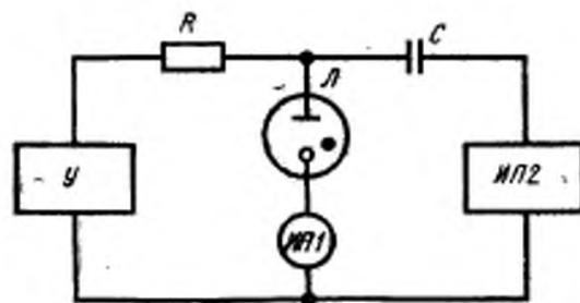
*R*—резистор; *C*—конденсатор; *ИП1*—измеритель тока; *ИП2*—электронный милливольтметр; *L*—испытываемый стабилитрон; *U*—регулируемый источник постоянного напряжения.
