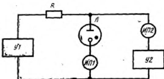
$R$ —резистор, ИП1—измеритель тока, ИП2—измеритель напряжения,  $L$ —испытываемый стабилитрон,  $U$ —регулируемый источник постоянного напряжения,  $U_2$ —источник опорного напряжения.
