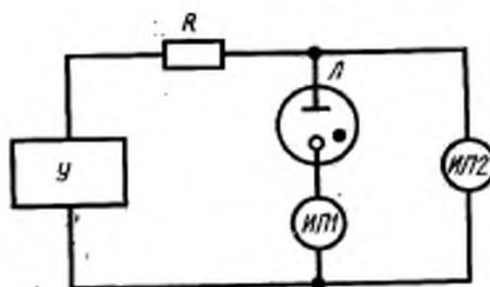
*R*—резистор; *ИП1*—измеритель тока; *ИП2*—измеритель напряжения; *Л*—испытываемый стабилитрон; *У*—регулируемый источник постоянного напряжения
