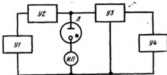
ИП — измеритель тока; Л — испытываемый стабилизатор;
