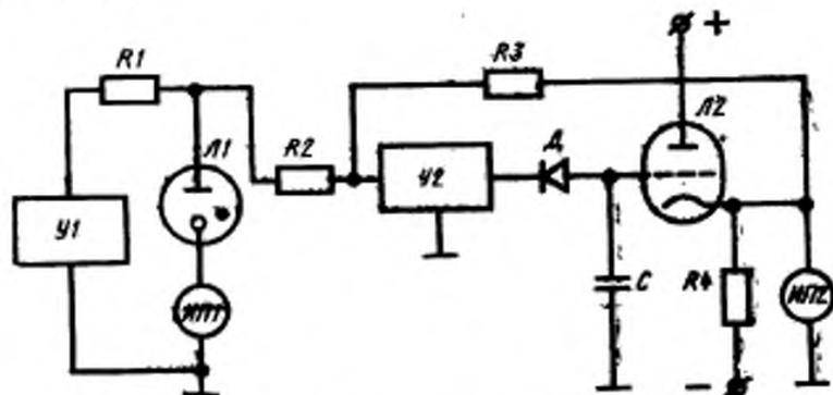
$R1, R2, R3, R4, R5$ —резисторы;  $C$ —конденсатор;  $D$ —диод;  $ИП1$ —измеритель тока;  $ИП2$ —измеритель напряжения;  $A1$ —испытываемый стабилизатор;  $A2$ —триод;  $U1$ —регулируемый источник постоянного напряжения;  $U2$ —усилитель постоянного тока.
