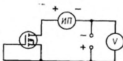
*V* — измеритель напряжения; *ИП* — измеритель тока
