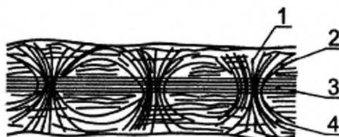
1 — вертикальное соединение; 2, 4 — слой волокон (прочес), 3 — каркас
