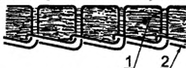
1 — волокистый прочес, 2 — нити цепного стежка (переплетение «цепочка»)
