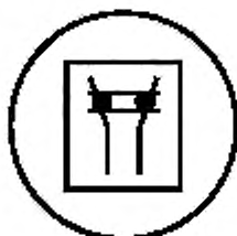
Рисунок L.2 — Символ маркировки аппарата, содержащего механически связанные контакты
