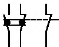
Рисунок L.1 — Пример схемы механически связанных замыкающего и размыкающего контактов и несвязанного размыкающего контакта
