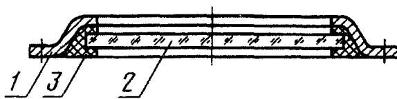
1 — корпус; 2 — стекло; 3 — герметизирующий материал
