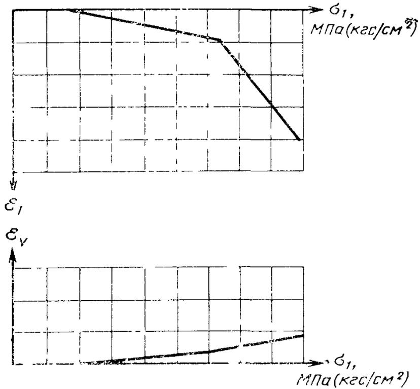
**ОПРЕДЕЛЕНИЕ МОДУЛЯ СДВИГА  $G$  И МОДУЛЯ ОБЪЕМНОЙ
