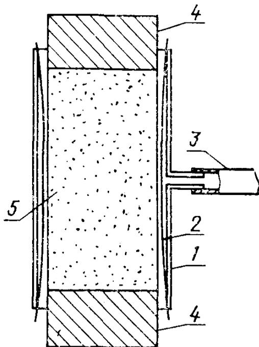
1 — металлический цилиндр; 2 — резиновая оболочка; 3 — гибкая трубка к источнику разрезания; 4 — штампы; 5 — образец грунта
