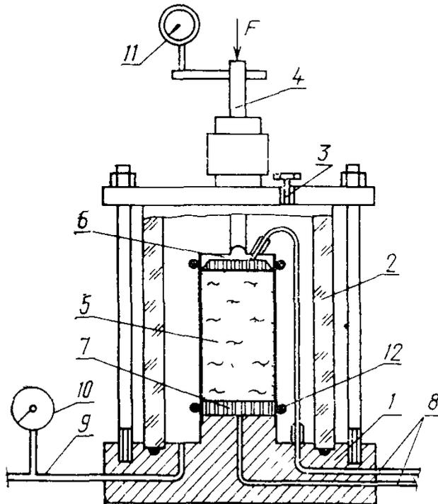
1 — основание камеры, 2 — корпус камеры, 3 — вентиль для выпуска воздуха, 4 — шток, 5 — образец грунта в оболочке, 6 — верхний штамп; 7 — нижний штамп, 8 — трубки для дренирования и измерения давления в поровой воде, 9 — трубка для заполнения камеры и измерения давления в камере, 10 — манометр, 11 — индикатор; 12 — уплотнитель
