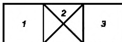
1 — источник звука; 2 — испытуемый объект; 3 — оборудование на приемной стороне
