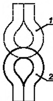
1 — промежуточное положение шланга, 2 — положение шланга в начале и в конце каждого изгиба
