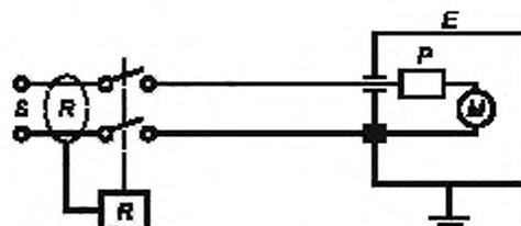
S — питание; E — кожух электродвигателя; R — устройство защитного отключения ( $I_{\Delta n} = 30$  мА) (выключатель или выключатель с защитой от перегрузки); P — защитное устройство (внешнее или внутреннее); M — электродвигатель
