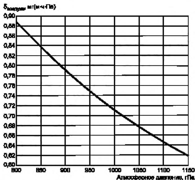
Рисунок 1 — Паропрооницаемость воздуха при 23 °C
