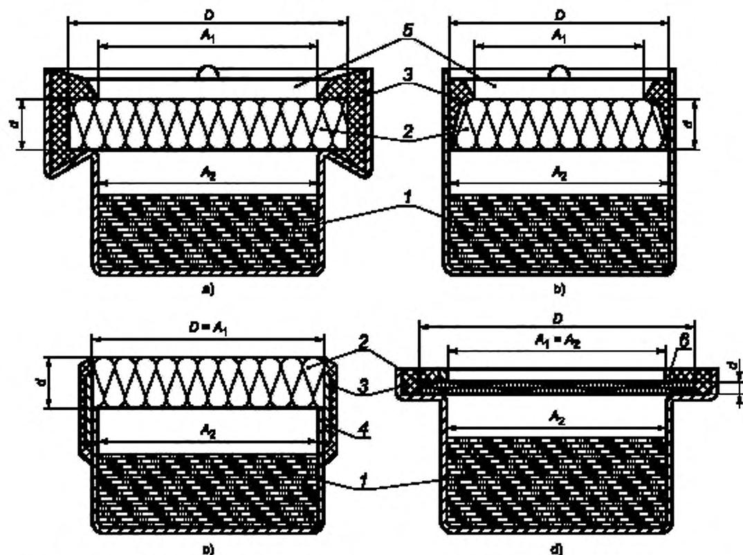
1 — влагопоглотитель/насыщенный водный раствор соли; 2 — образец для испытания; 3 — герметизирующий состав, 4 — герметизирующая лента; 5 — обойма; 6 — ограничительное кольцо.  $A_1$  — верхний открытый участок образца;  $A_2$  — нижний открытый участок образца;  $D$  — площадь образца,  $d$  — толщина образца;  $A$  — среднее значение площадей открытых участков образца,  $A = (A_1 + A_2)/2$
