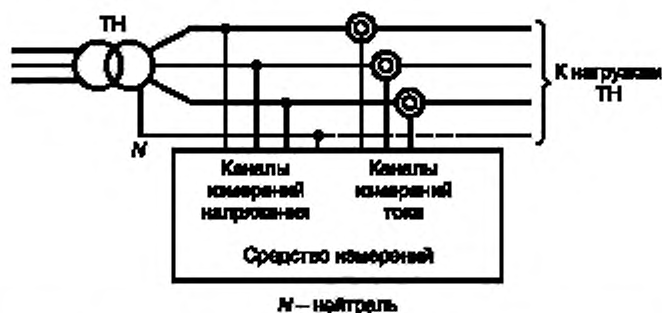
Рисунок Б.8 — Схема измерений мощности нагрузки вторичных цепей ТН
