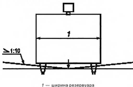
Рисунок 2 — Зазор между резервуаром и полом
