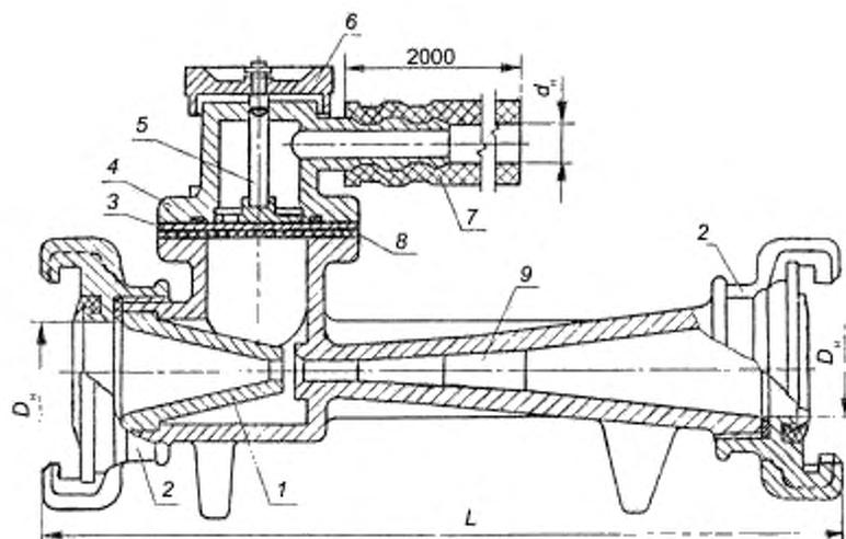
1 — сопло; 2 — соединительная головка; 3 — шайба дозирующая; 4 — корпус дозатора; 5 — дозатор; 6 — маховик;
