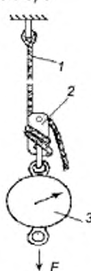
1 — канат; 2 — тормозное устройство; 3 — динамометр
