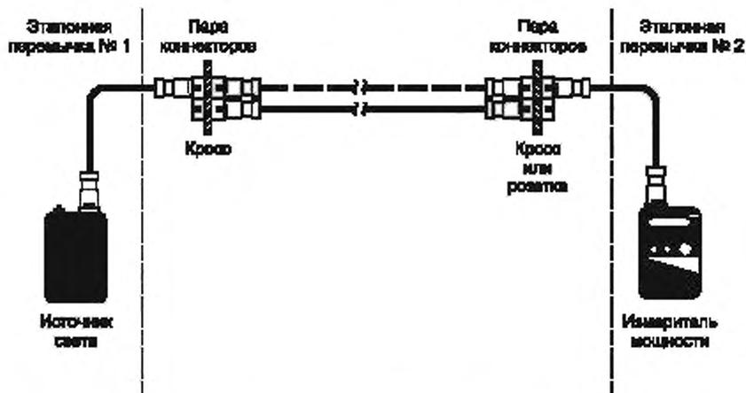
Рисунок 8 — Калибровка 4 — измерение значения мощности затухания
