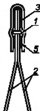
Сшивка с последующей оклейкой лентой; лента поверх шва
