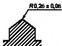
Рисунок 3 — Призма, применяемая в испытательном устройстве для измерения точки равновесия
