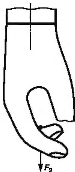
Рисунок 4 — Схема испытания фиксатора пальцев
