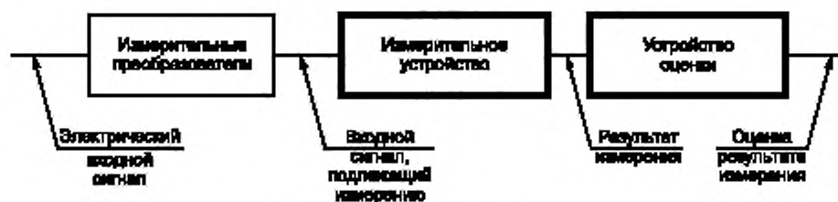
Рисунок 1 — Полная измерительная цепь
