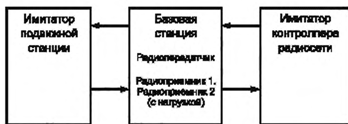
Рисунок 1 — Схема испытаний на помехоустойчивость базовой станции
