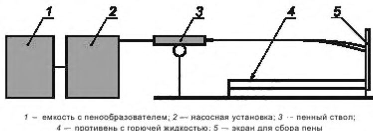
Рисунок 1 — Схема установки для определения времени тушения горючей жидкости при подаче пены низкой кратности в борт противня
