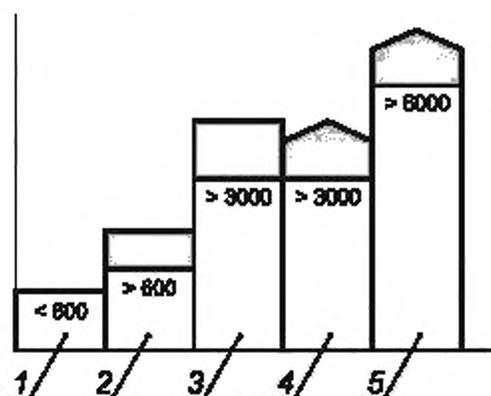
1 — не требуются ограждающие стены; 2 — необходимы ограждающие стены с рост посетителя; 3 — необходимы ограждающие стены в 1,25 раза выше роста посетителя; 4 — необходима постоянная крыша; 5 — необходимы ограждающие стены и крыша
