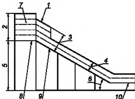
1 — первый метр участка скольжения; 2 — высота ограждающей стены начального участка; 3 — высота ограждающей стены, равная росту посетителя; 4 — высота ограждающей стены, равная 50 % роста посетителя; 5 — высота свободного падения; 6 — угол склона более 30°; 7 — ограждающая стена начального участка; 8 — поверхность начального участка; 9 — участок скольжения; 10 — конечный участок
