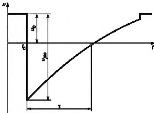
$t_0$  — момент разрушения оболочки;  $u_0$  — сигнал микрофона, соответствующий давлению внутри оболочки перед ее разрушением, отсчитываемому относительно атмосферного давления;  $u_{psc}$  — скачок напряжения в момент разрушения оболочки;  $\tau$  — низкочастотная постоянная времени микрофонной системы
