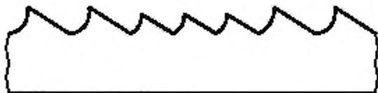
Рисунок 10 — Форма с переменным шагом зубьев
