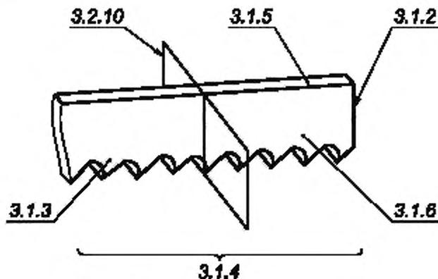
Рисунок 1 — Элементы полотна пилы
