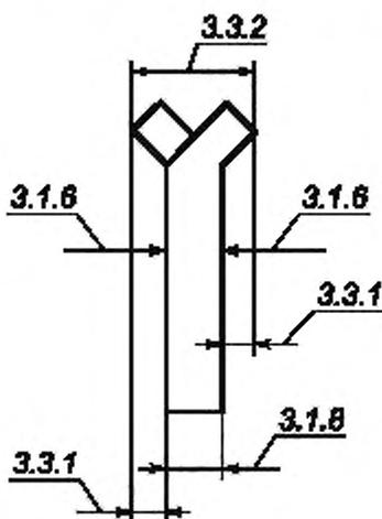
Рисунок 3 — Разводка зубьев и общая разводка
