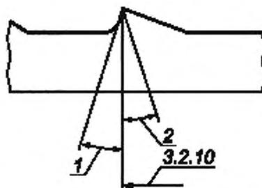
1 — отрицательный передний угол; 2 — положительный передний угол
