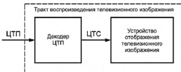
Рисунок 8 — Структура тракта воспроизведения цифровых телевизионных сигналов высокой четкости
