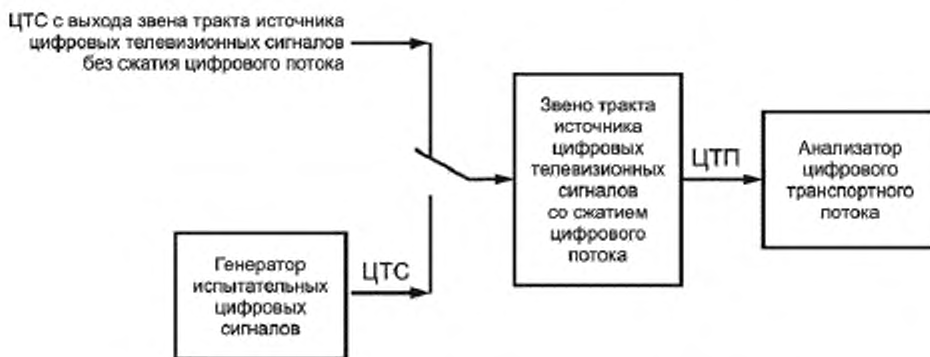
Рисунок 4 — Измерение параметров звена тракта источника цифровых телевизионных сигналов со сжатием цифрового потока
