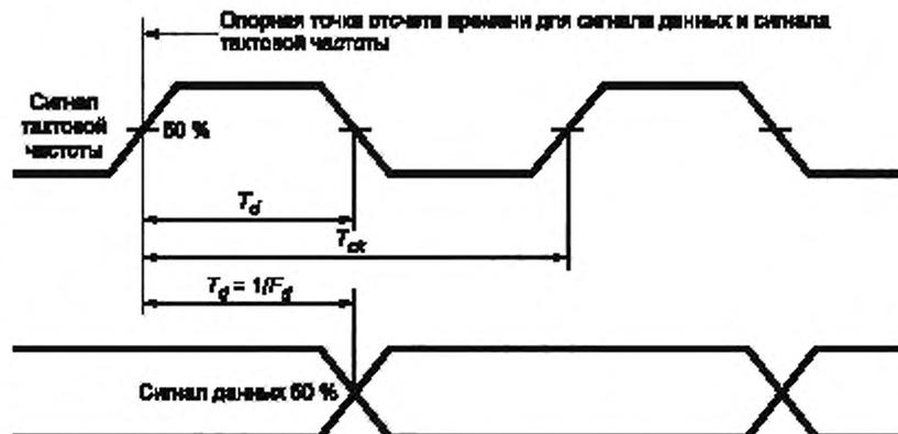
Рисунок 7 — Соотношения параметров синхронизации сигнала и данных
