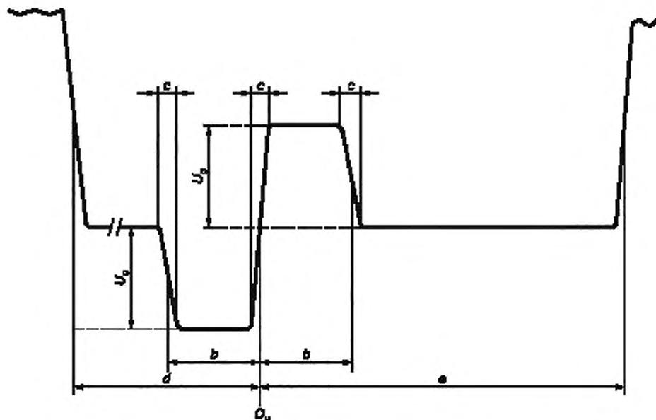
Рисунок 2 — Структура сигнала синхронизации на интервале гашения строки
