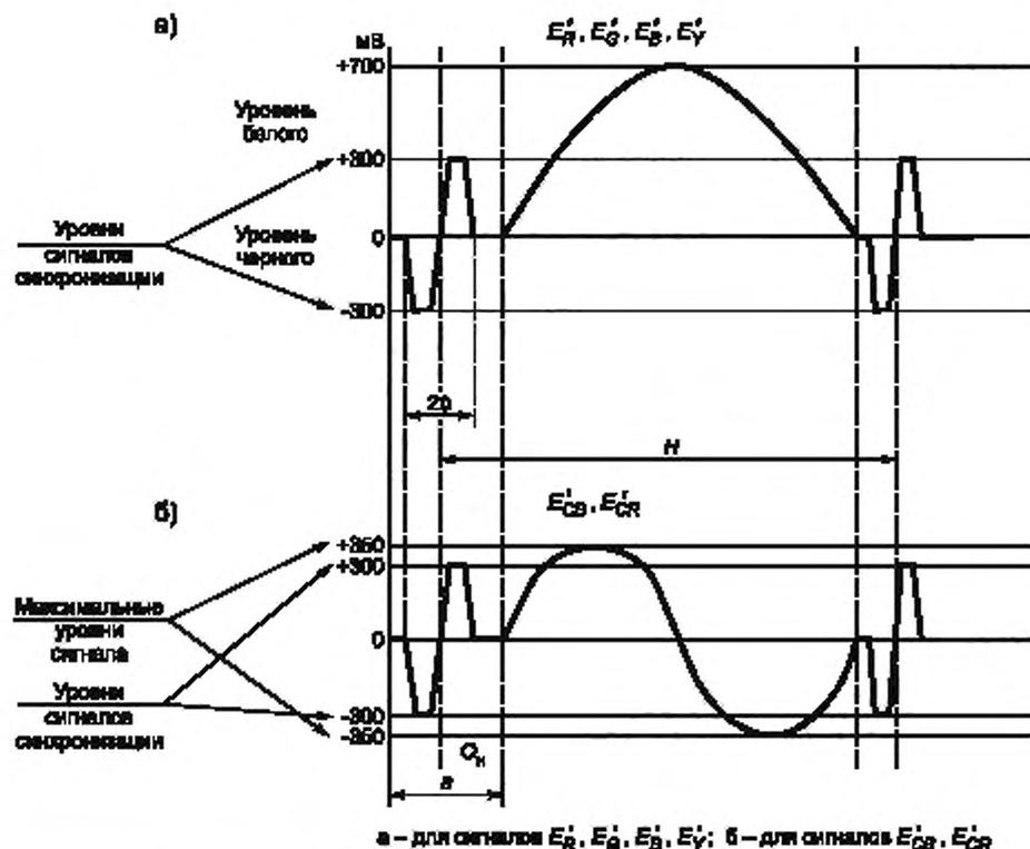
Рисунок 1 — Структура компонентных сигналов на интервале строки
