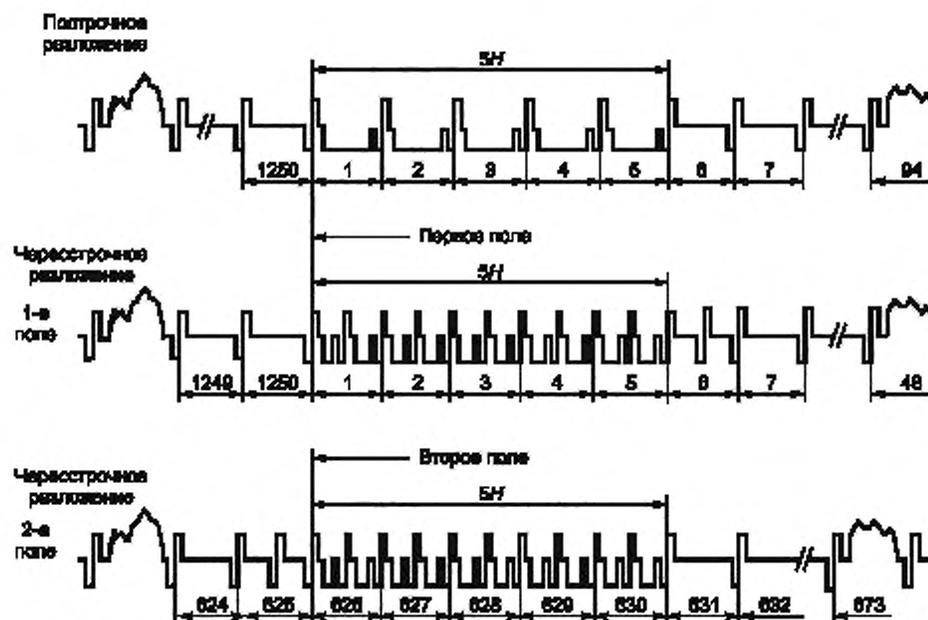
Рисунок 3 — Структура синхросигнала на интервале гашения поля
