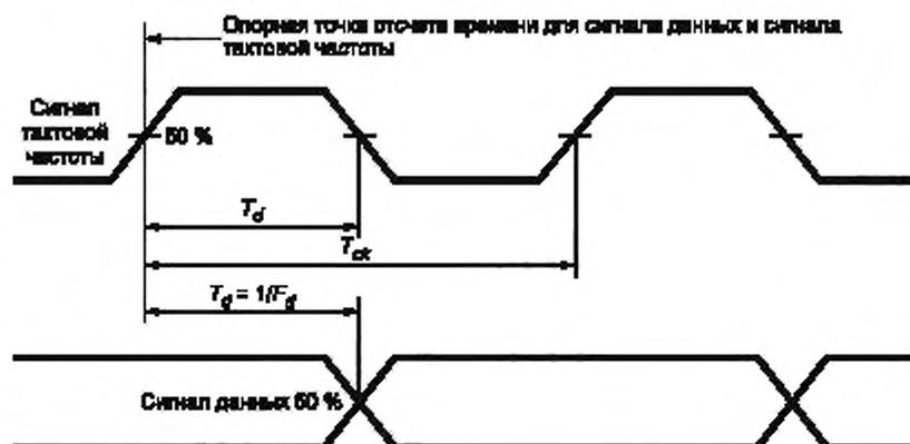
Рисунок 7 — Соотношения параметров синхронизации сигнала и данных
