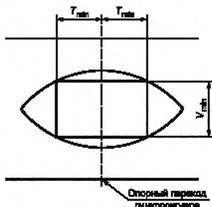
П р и м е ч а н и е — Ширина окна глазковой диаграммы, в пределах которого данные должны быть правильно детектированы, включает фазовое дрожание сигнала тактовой частоты ± 0,4 $T$ , синхронизацию данных ± 0,075 $T$  и скос за счет распространения в проводящих парах ± 0,18 $T$ .  $T_{min} = 0,3T$ ;  $V_{min} = 100$  мВ.
