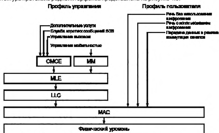
Рисунок 4.6 — Архитектура радиоинтерфейса TETRA V + D (TMO) ( U_m )
