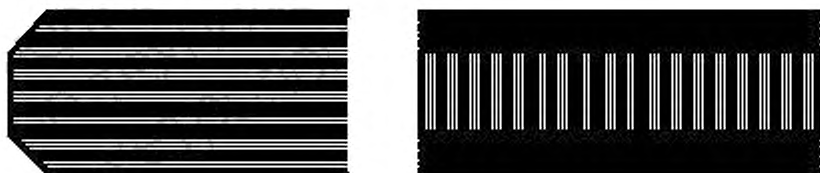
Рисунок А.3 — Гладкошлифованная кромка
