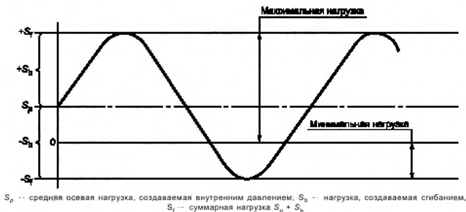
Рисунок 4 — Стандартный цикл переменной нагрузки при внутреннем давлении
