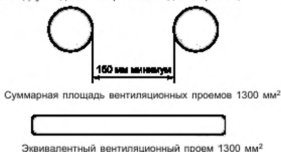
Рисунок 7— Пример разных конструкций вентиляционных отверстий
