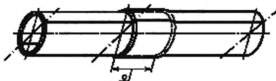
Рисунок D.3 — Контрольное соединение. Муфтовое нахлесточное соединение
