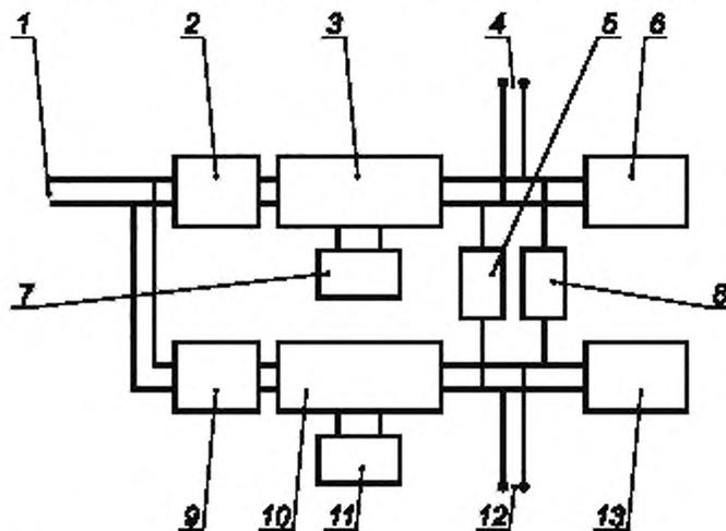
1 — электрическая сеть; 2 — дополнительный фильтр; 3 — ЭСП I; 4 — порт II; 5 — дроссель индуктивностью 660 мкГн; 6 — оборудование связи; 7 — резистор сопротивлением 50 Ом, подключаемый к измерительным разъемам ЭСП I; 8 — дроссель индуктивностью 660 мкГн; 9 — дополнительный фильтр; 10 — ЭСП II; 11 — резистор сопротивлением 50 Ом, подключаемый к измерительным разъемам ЭСП II; 12 — порт I; 13 — испытуемое ТС.
