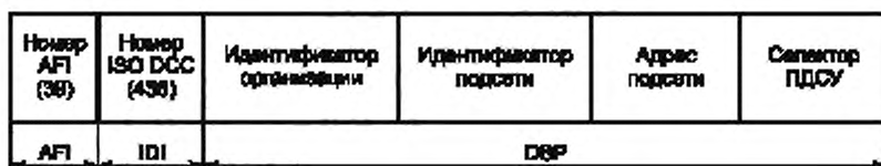
Рисунок 15 — Формат сетевого адреса КДС ИСО (ISO DCC)
