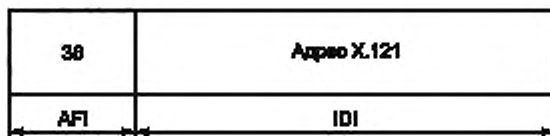
Рисунок 16 — Пример формата сетевого-адреса X.121
