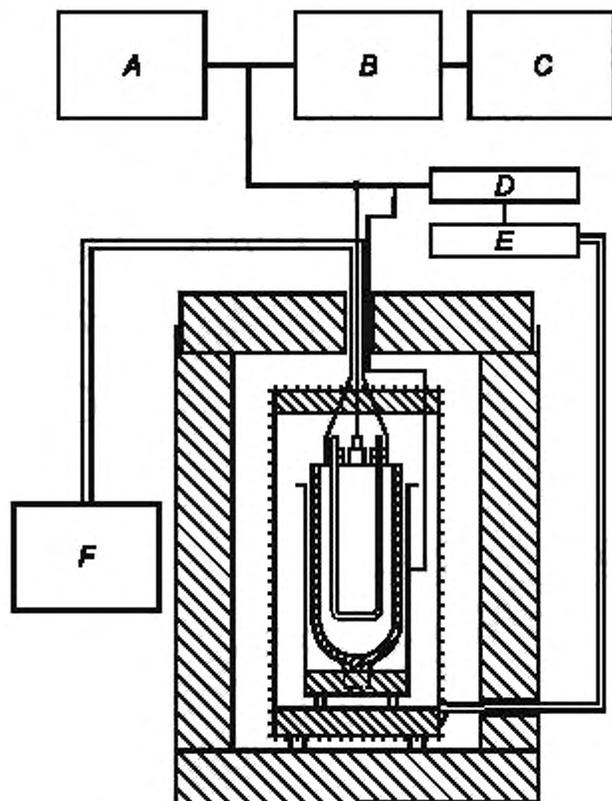
А — многоточечный регистратор и регулятор температуры (10 мВ); В — наружная установка на ноль; С — записывающее устройство высокой точности; D — управление; E — реле; F — внутренний первичный нагреватель
