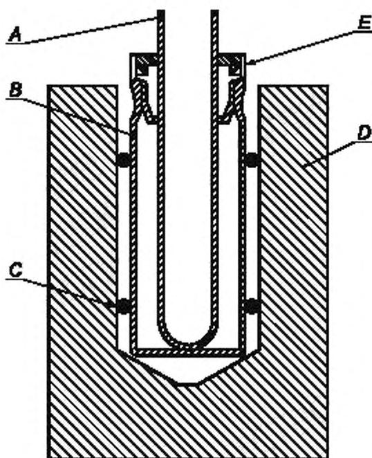
A — стеклянная трубка; B — стеклянный флакон (12 мл в комплекте А, 16 мл в комплекте В);
