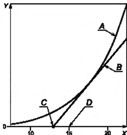
A — кривая тепловыделения; B — прямая с градиентом, равным скорости теплоотдачи, проведенная по касательной к кривой тепловыделения; C — критическая температура окружающей среды (пересечение линии теплоотдачи с абсциссой); D — ТСУР — критическая температура окружающей среды, округленная до более высокого значения, кратного 5 °С; X — температура; Y — тепловой поток на единицу массы
