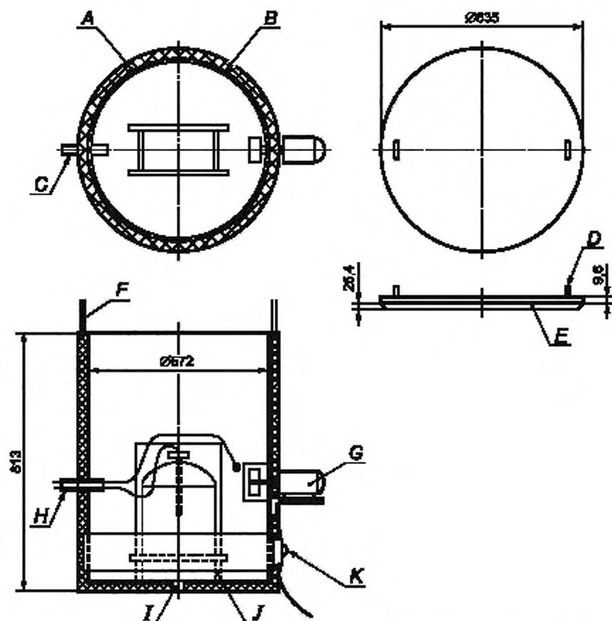
A — изоляция толщиной 25 мм; B — барабан без дна, 220 л; C — труба, 19 мм; D — стержень с петлей, 9,8 мм; E — изоляция на стальном покрытии; F — контрольный кабель, 3 мм; G — вентилятор; H — термодары и контрольные приборы; I — дренаж; J — угловая стойка, 25 мм; K — нагреватель барабана, 2 кВт
