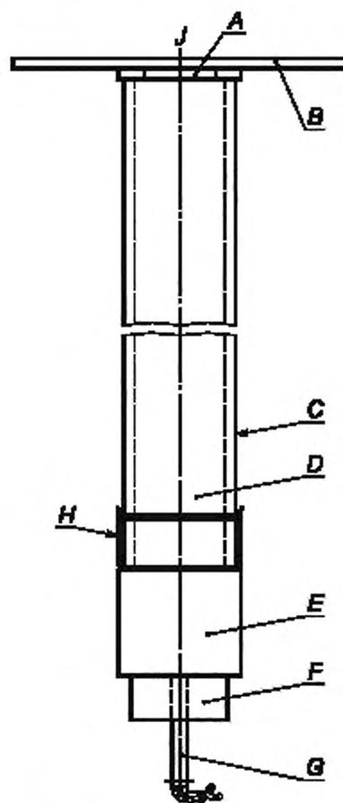
A — прокладки; B — контрольная пластина; C — стальная трубка; D — испытуемая химическая продукция; E — бустер, состоящий из циклотриметилентринитрамина/парафина или ТЭН/тринитрата; F — держатель детонатора; G — детонатор; H — пластмассовая мембрана; J — датчик скорости
