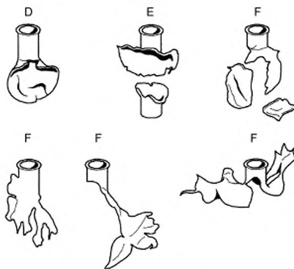
Рисунок 11 — Примеры разрушений видов «D», «E» и «F»
