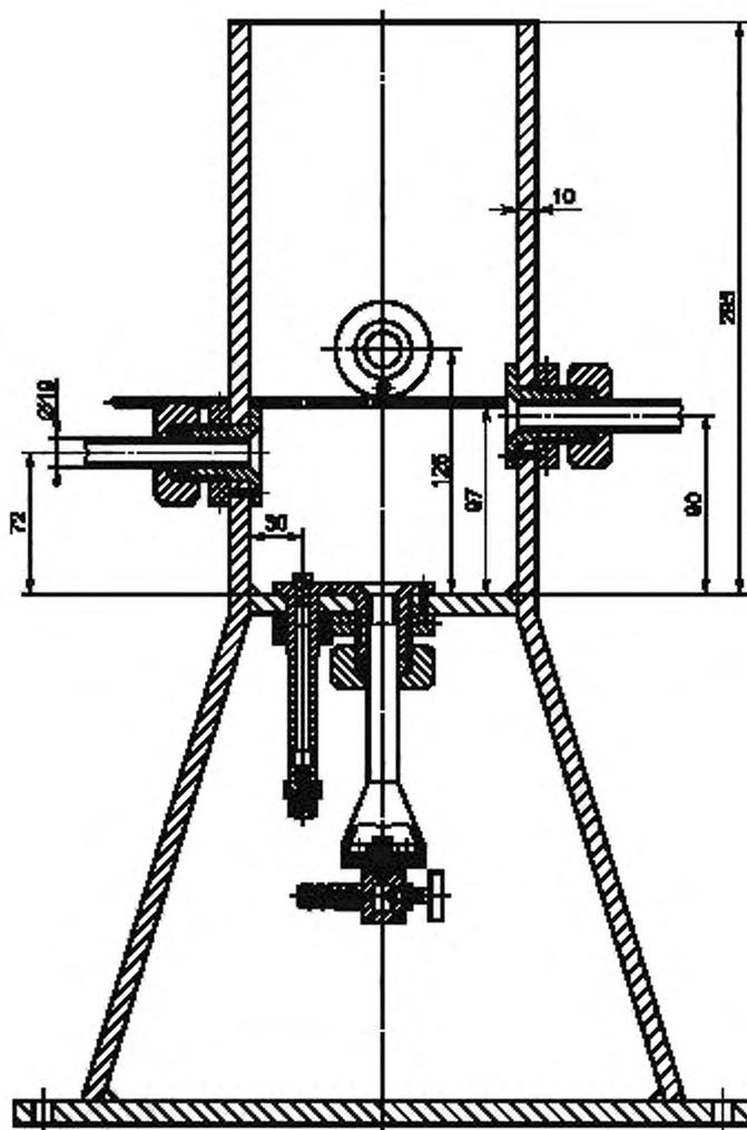
Рисунок 10 — Защитно-нагревательное устройство
