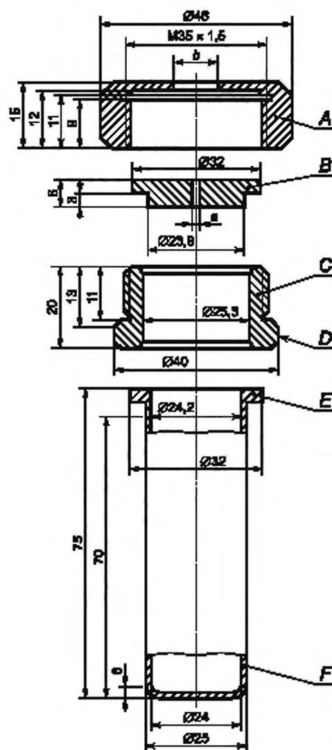
А — гайка ( $b = 10,0$  или  $20,0$  мм), рассчитанная на гаечный ключ 41; В — пластина с отверстием ( $a = 1,0 \times 20,0$  мм в диаметре);
