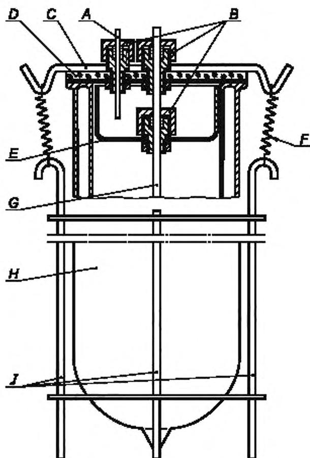
*A* — капиллярная трубка из ПТФЭ; *B* — специальные завинчивающиеся заглушки (из ПТФЭ или алюминия) с уплотнительными кольцами; *C* — металлическая планка; *D* — стеклянная крышка; *E* — основание стеклянного резервуара; *F* — пружина; *G* — стеклянная защитная трубка; *H* — сосуд Дьюара; *J* — стальное поддерживающее устройство
