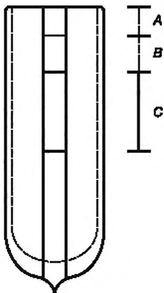
А — высота наполнения — 20 мм ниже верхней кромки; В — устанавливаемая 30-миллиметровая зона дефлаграции;
