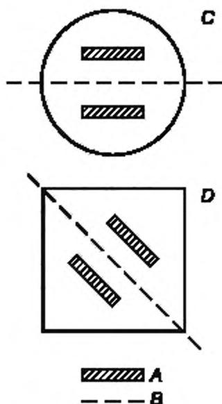
A — заряды взрывчатой химической продукции; B — линия симметрии; C — цилиндрическая упаковка (вид сверху);
