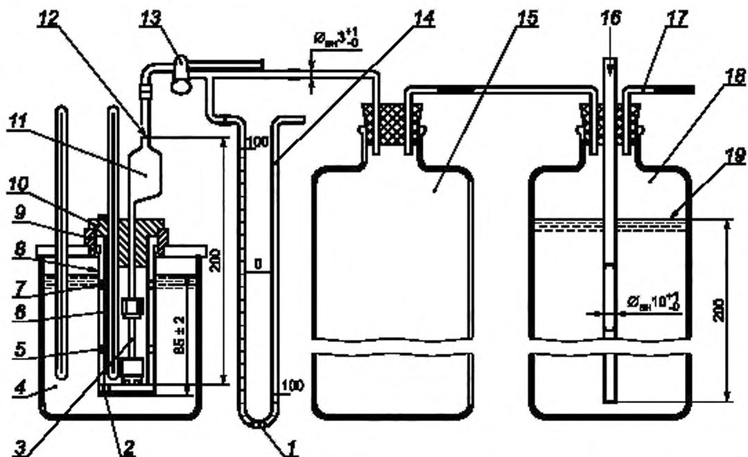
1 — вода, 2 — изолирующее кольцо, 3 — фильтр, 4 — охлаждающая баня, 5, 7 — прокладка, 6 — испытательный сосуд, 8 — кожух, 9 — поддерживающее кольцо, 10 — пробка, 11 — пилетка, 12 — отметка  $20\text{ см}^3$ , 13 — запорный кран с двойным наклонным каналом, 14 — U-образный манометр, 15 — дополнительный вакуумный резервуар, 16 — воздушный клапан, 17 — источник вакуума, 18 — вакуумный резервуар, 19 — уровень воды
