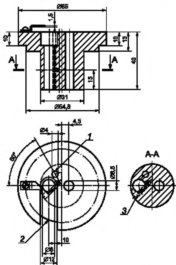
1 — вентиляционное отверстие; 2 — паз для снятия показаний термометра до минус 30 °С; 3 — зажим из пружинной проволоки из нержавеющей стали для удерживания термометра
